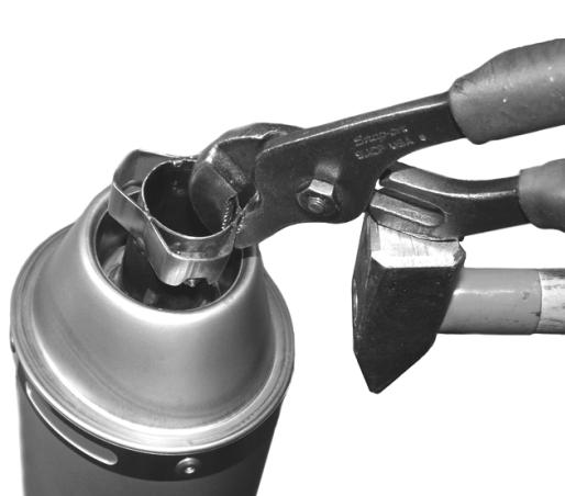
4) Greifen Sie jetzt den db-eater mit einer Zange, und schlagen diesen gleichmäßig und vorsichtig mit einem Hammer raus.
