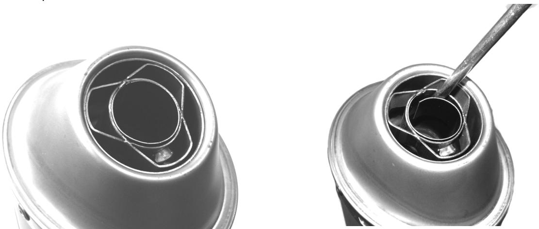
1) Innerhalb des db-eaters ist ein kleiner Ring mit einer Schraube. Oben ist dieser Ring angeschweisst
