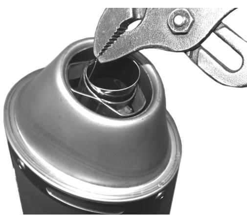
3) Ziehen Sie den Ring heraus und lösen Sie dann die Schraube mit Hilfe eines Imbusschlüssel
